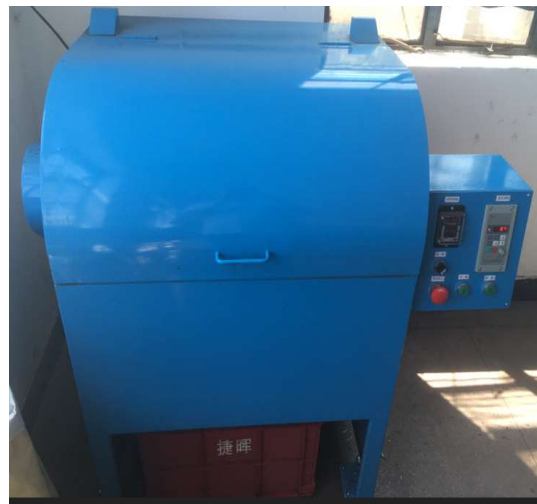
电木骨架去排气口毛边
